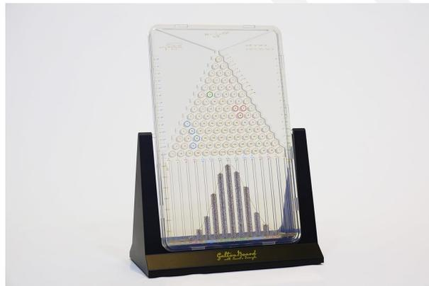
FIGURE 1.1 – Planche de Galton, dispositif expérimental portable illustrant le phénomène TLC.
